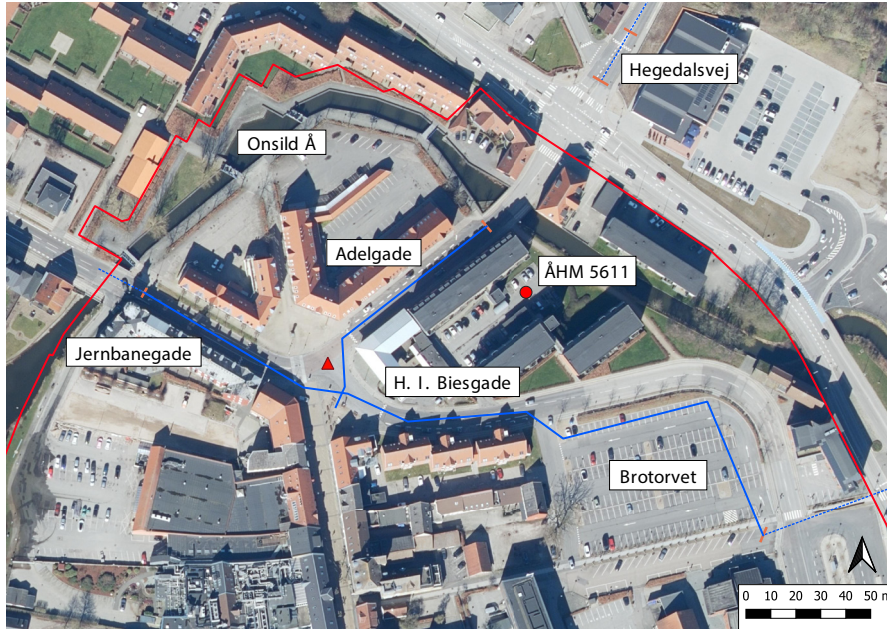
Figur 1. Oversigtskort over det undersøgte område. Med blå streg er markeret de projekterede kloaktracéer, mens Hobros kulturarvsareal er markeret med rød streg. Den røde trekant markerer den omtrentlige placering af det tidligere "Sprittorv".
