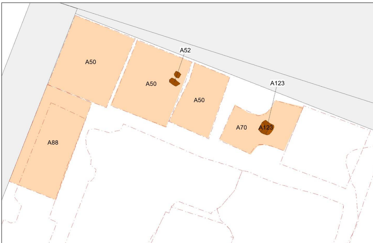
Bygning A126. Bygningen er registreret i støbegrøfterne langs de stående mure. Den orange farve er gulvlag. Pælene er brune.
