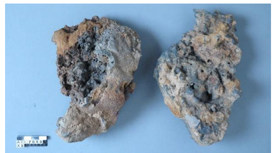
Figur 7: Slagge fra jernudvindingsovnen
