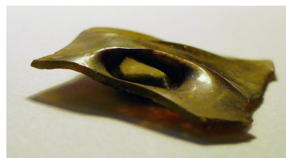
Planglas der er knebet sammen med en tang, formodentlig i forbindelse med åbning af cylinderen.
