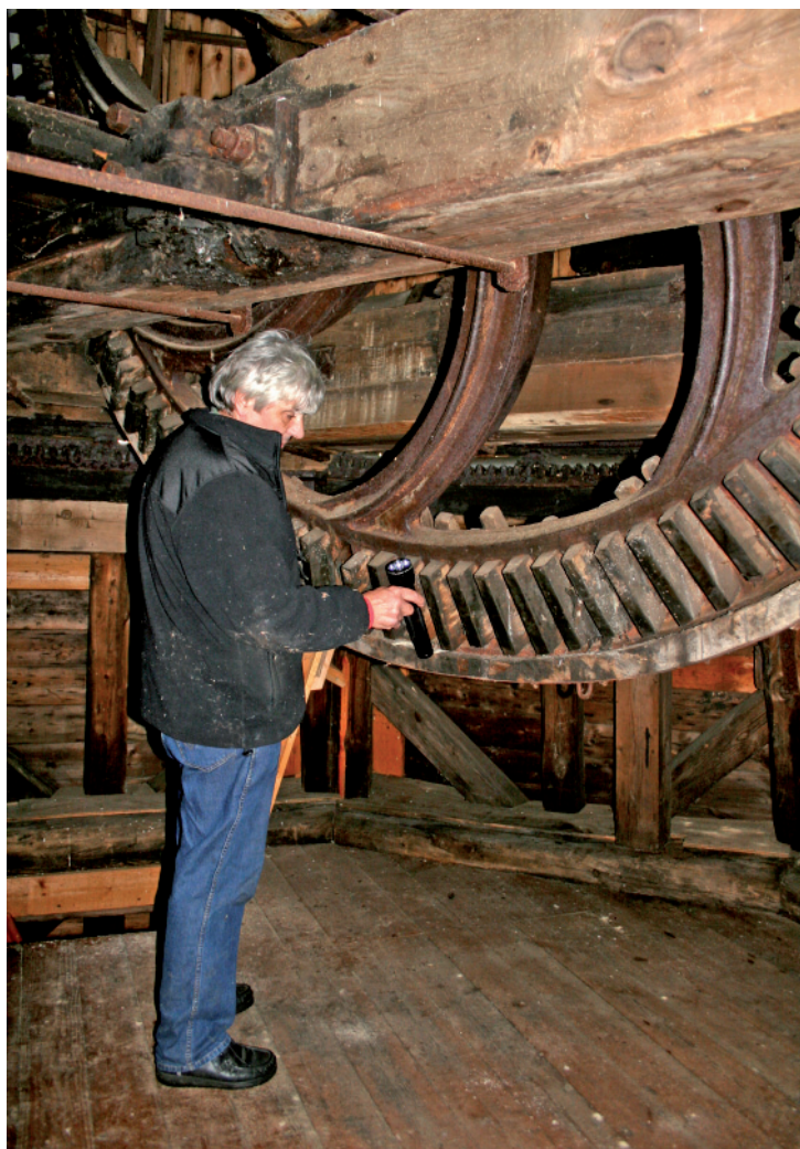
Det gigantiske hattehjul i pumpemøllen ved Bygholm har tænder, der er lige så høje som stavlygten (25 cm).
