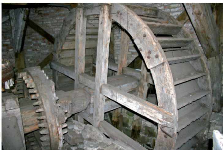
Gammel Viffertsholm Møllens vandhjul med de originale skovle er regionens bedst bevarede underfaldshjul.
